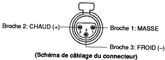
Les entrées doivent être utilisées avec des microphones symétriques de 50 — 600 ohms ou des lignes symétriques de 600 ohms. Le niveau d'entrée nominal dépend du réglage de la commande GAIN et de l'atténuateur PAD correspondants.
