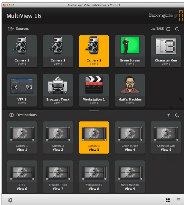
Selección de fuentes para las distintas ventanas del dispositivo MultiView 16 mediante el programa Videohub Control.
